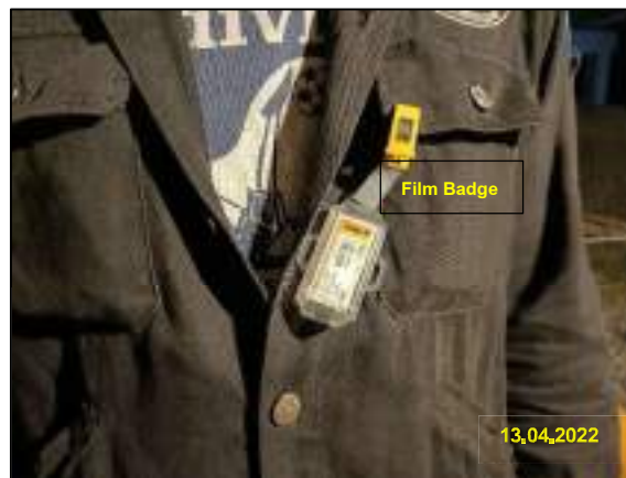
ก) การสวมใส่อุปกรณ์ป้องกันอันตรายส่วนบุคคลผู้เกี่ยวข้องในการตรวจสอบรอยเชื่อมด้วยวิธีทดสอบ ที่ไม่ทำลายสภาพ และ Film Badge
